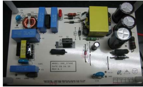
그림 10. 제안된 Single-stage LED 구동 회로
