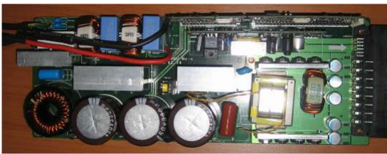
그림 6 제안회로 적용 1.2KW 컴퓨터 서버용 전원장치
