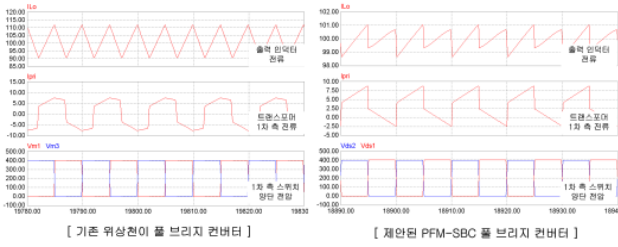
그림 5 기존 위상천이 풀 브리지 컨버터와 제안된 Double-ended 능동 클램프 풀 브리지 컨버터의 모의실험 비교
