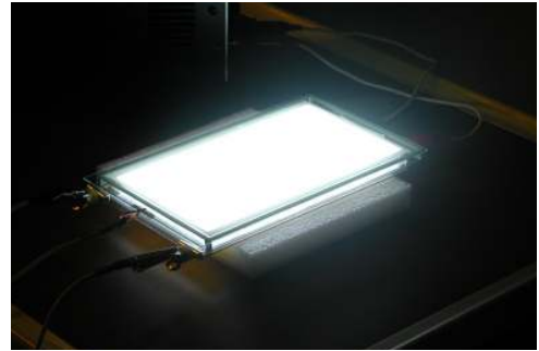
그림 9 CNT를 이용한 램프의 구동모습 Fig. 9 The photograph of field emission lamp with CNT emitter
