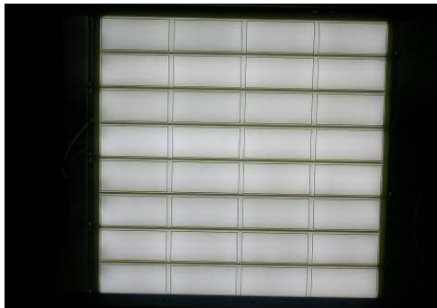
그림 8 제논을 이용한 램프의 구동 시 모습 Fig. 8 The photograph of field emission lamp with Xe
