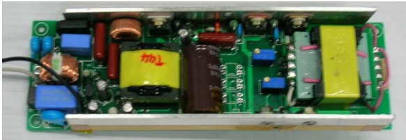
그림 5 안정기의 실제 모습 Fig. 5 The photograph of ballast
