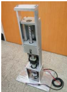
그림 8. 제작 완성된 Electromagnetic Damper
