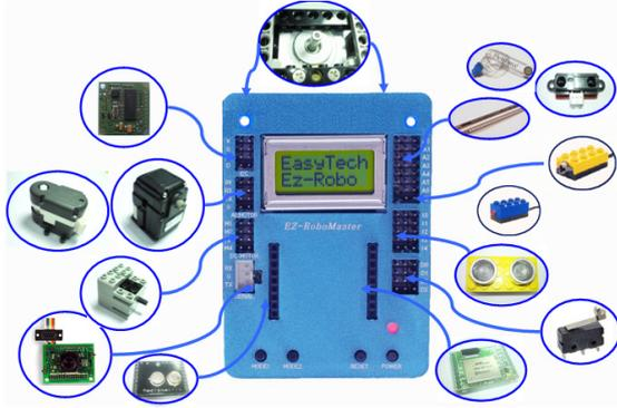
그림 1. Ez-RoboMaster와 센서, 구동장치 연결
