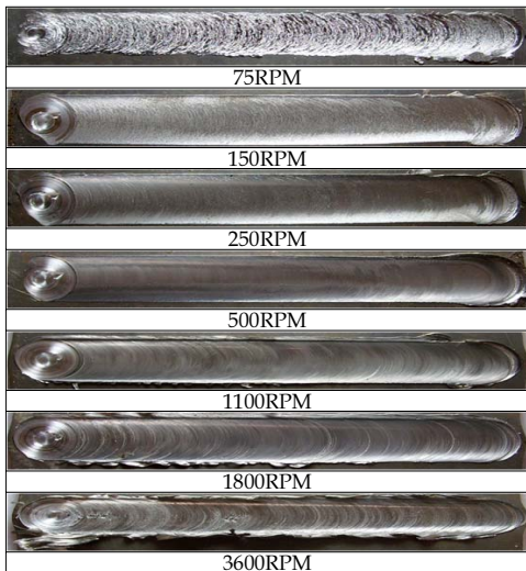
Fig. 1 15mm/min에서 회전속도 변화에 따른 시편 외관
