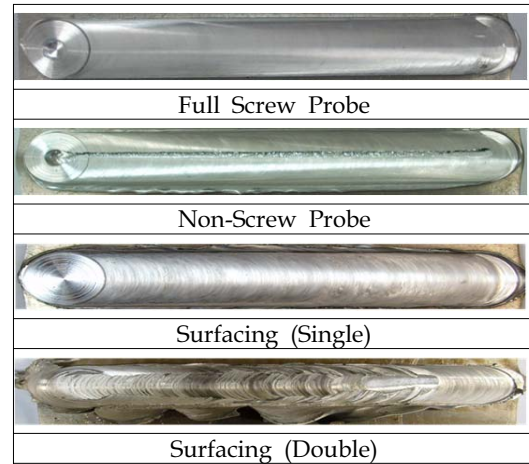
Fig. 2 다양한 공구 형상에 따른 시편 외관
