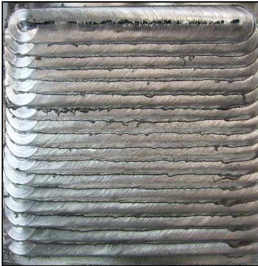
Fig. 2 1600RPM, 15mm/min에서 Multi-pass FSP를 실시한 시편 외관
