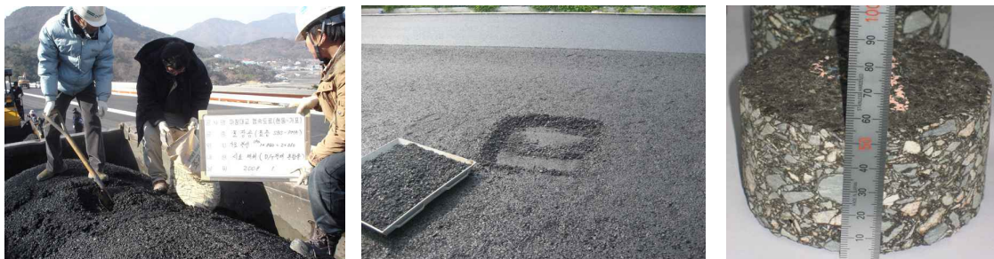
〈그림 2〉 아스팔트 혼합물 채취 및 채취된 아스팔트 코어 시료
