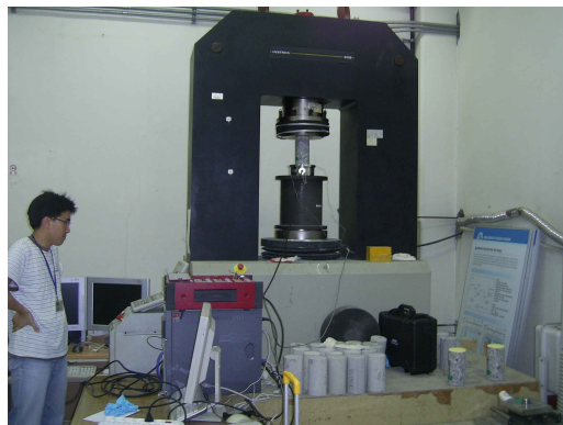
<사진 5> 응력-변형률 관계 시험 모습
