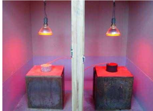
<사진 1> 포장온도 저감량시험
