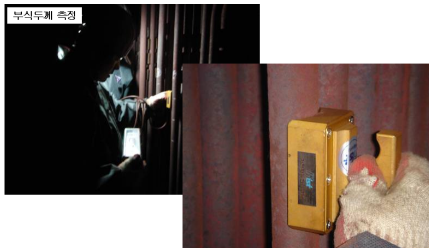
그림 5. 보일러 튜브 부식두께 측정
