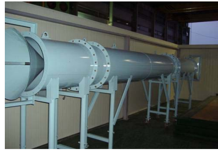
Fig. 10 Duct for Fan Test
