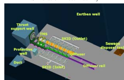
Fig. 2 Lay-out of test stand for the HAT
