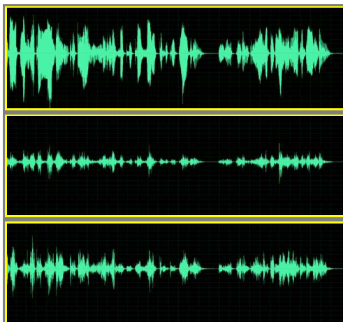
그림 8. 원 신호(음성)와 잔차 신호의 비교 (위로부터 원본, 비음성 행렬 인수분해 사용 후의 잔차 신호, 주성분분석 사용 후의 잔차 신호 M=8, R=2 인 경우)
