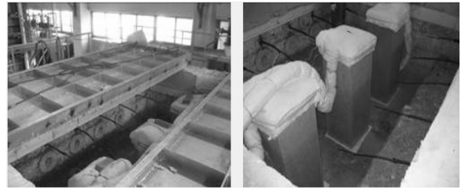
사진 1. 고강도콘크리트 내화시험 장면
