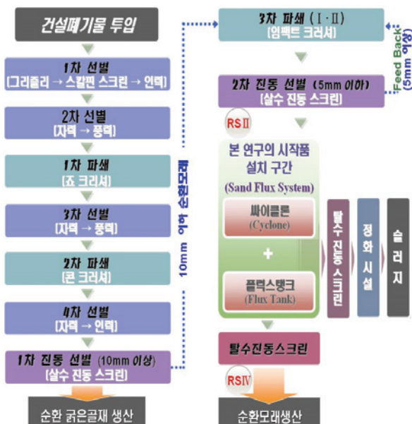
그림 1. 건설폐기물 중간처리업체의 순환골재 생산공정도
