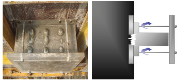
그림 1. 접합분리 시험체의 설치 및 사용법
