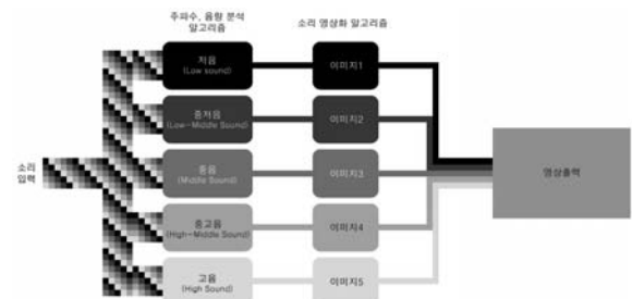
그림 4. 사운드 그래픽 이퀄라이저의 각 부분별 알고리즘 구성
