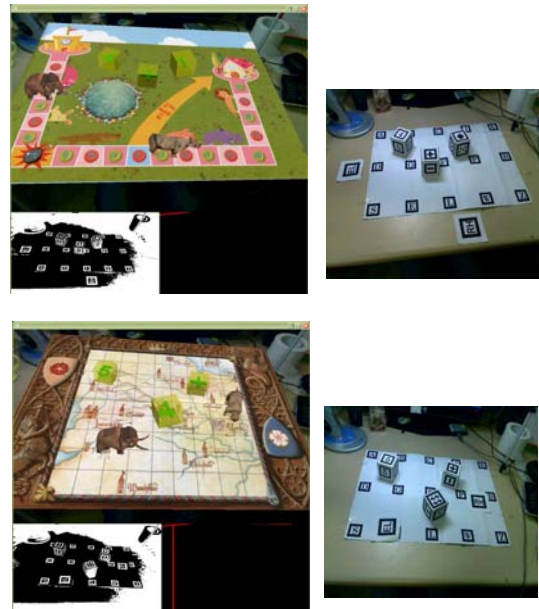
그림 7. 매직북 형태의 보드판과 3차원 모델, 주사위 마커와 연산자 마커 뒷면을 증강시킨 화면
