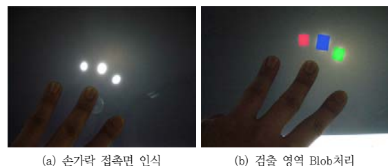
그림 9. 적외선의 난반사를 이용한 손가락 접촉면 인식 및 해당 영역 Blob처리 결과
