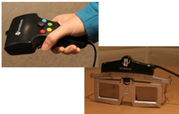
그림 11. 3차원 마우스와 편광필터 안경에 부착된 Head Tracker
