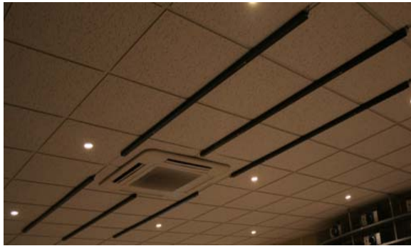
그림 10. 천장에 부착된 IS-900 SoniStrips
