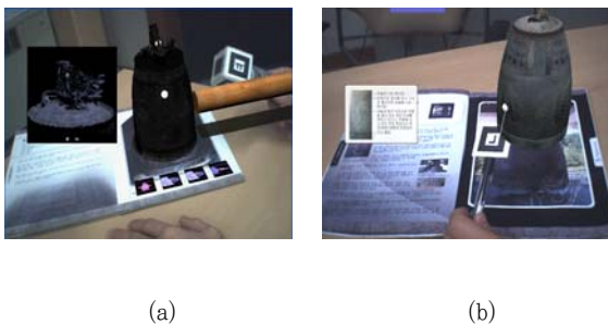
그림 8. 감각형 객체를 이용하여 범종의 특정 부분을 지적 (Pointing) 하여 특정 설명을 볼 수 있는 것.
