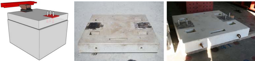
그림 4. 강판보강 앵커용접형 프리캐스트 바닥판-레일 체결구조 실험체
