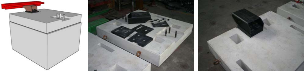
그림 2. 매립형 앵커형 프리캐스트 바닥판-레일 체결구조 실험체
