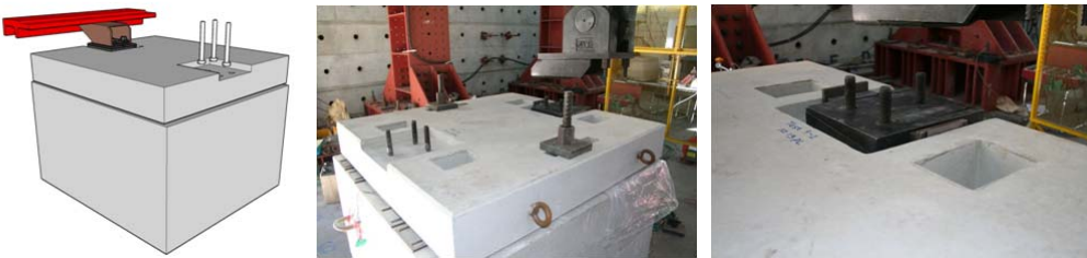
그림 3. 그라우팅 앵커형 프리캐스트 바닥판-레일 체결구조 실험체
