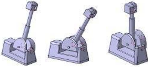
그림 3 해체장비용 햅틱 장치의 작동 모습
