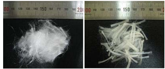
(a) PE (c) PVA 그림2. 보강섬유의 형상
