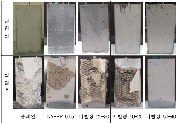
사진 1. 섬유 및 황구속제 조합에 따른 시험체의 폭발모습
