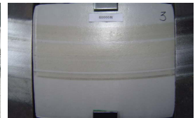
사진 6 윤하중 후 시험체
