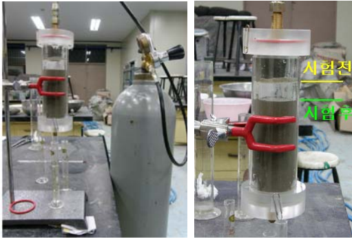
그림 5 시험 후 수분이 빠져나가 부피가 감소된 모습
