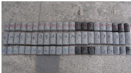
사진2. 코어시험체 채취(투수면 및 비투수면)
