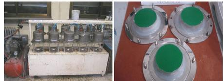
그림 7. 투수 시험현황 및 시험편
