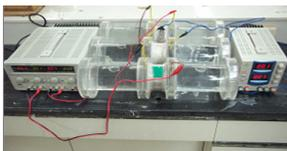
그림 1 RCPT 실험 전경
