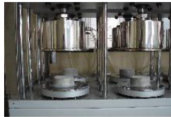
그림1. 실험체 설치과정 및 투수실험기
