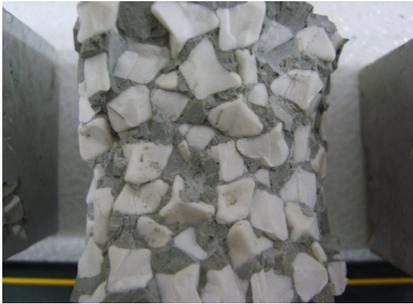
그림 5 세라믹1을 사용한 콘크리트
