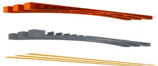
그림 2. CFTA 거더의 구성 재료(강박스, 콘크리트, 긴장재)
