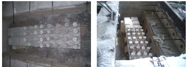
(a) 시험체 설치상황(시험전) (b) 시험 이후 시험체 현황 그림 1. HC에 의한 내화시험 전경(한국방재시험연구원)
