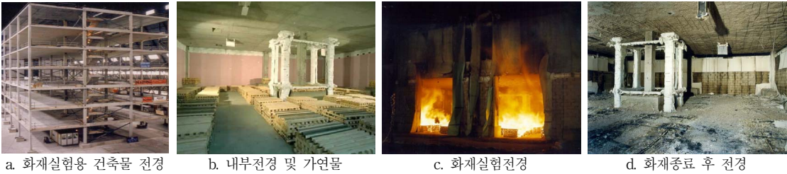
사진 3. BRE 콘크리트 건축 구조물의 내화성능
