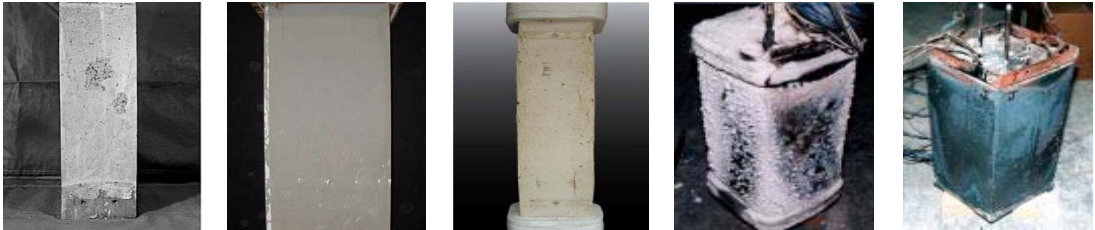
a. 유기섬유 & 강섬유혼입 b. 섬유혼입&내화피복 c. 폴리프로필렌 수지혼입 d. 발포형 내화도료 e. 강판에 의한 비산방지
