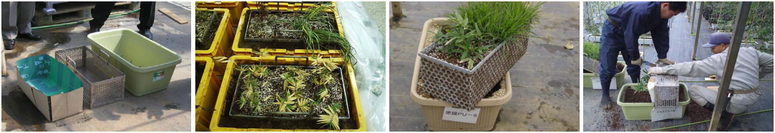
a) 식재/재료시험 준비 b) 식재 및 식재관리 c) 뿌리침입의 외관확인 d) 뿌리침입의 직접확인 사진 2. 방수 및 방근층의 방근 성능시험과정
