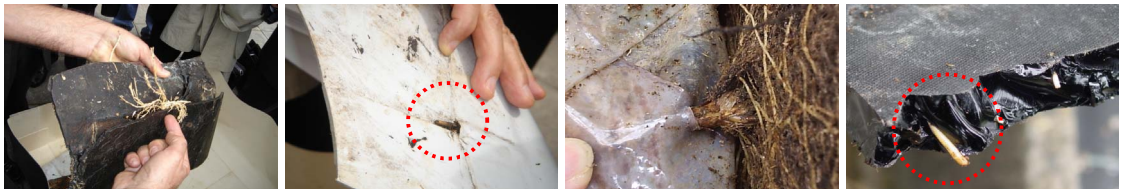
사진 3. 시험을 통한 방수 및 방근재료의 결과 예
