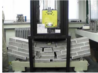
그림 5. 분절 복합체 충격하중 실험
