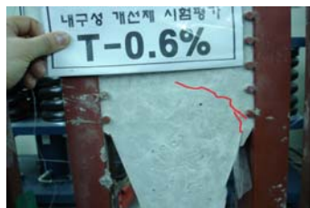
균열 발생일 : 54일
