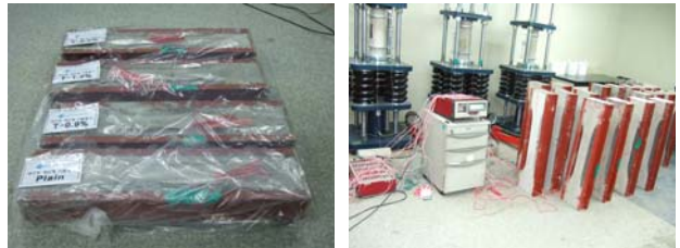
사진 1. 콘크리트 구속건조수축 시험사진
