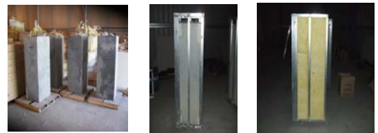
(a) 단주 시험체 (b) C-STUD 설치 (c) 단열재 설치
