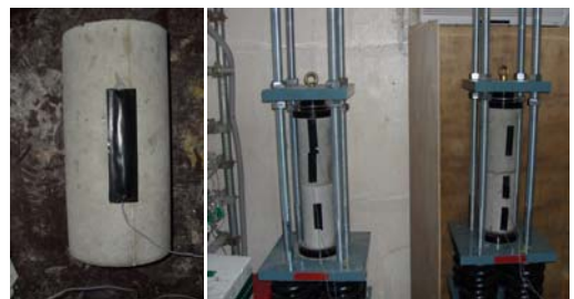
a) 스트레인 게이지 부착 b) 하중재하 및 스트레인 측정
