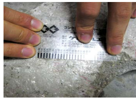
사진 1 Crack Scale을 이용한 균열면적 측정
