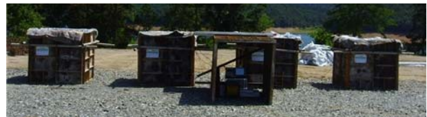
그림 4 Box 모형부재 타설 및 보양 모습
