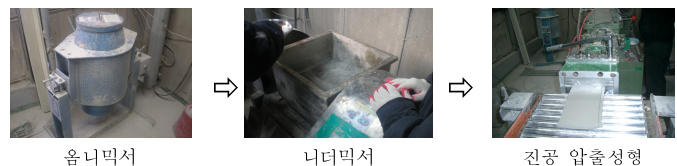
사진 1. 진공 압출성형 패널 제작 장면
