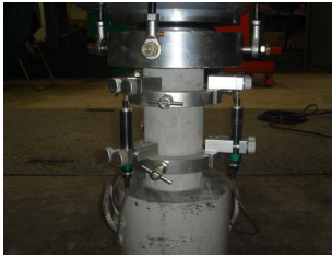
그림 1. 압축강도 및 탄성계수 실험
