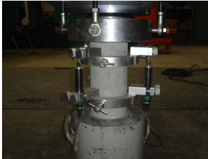
그림 1. 압축강도 및 탄성계수 실험
