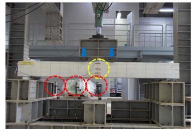
그림 2 실험전경 및 LVDT설치 위치
