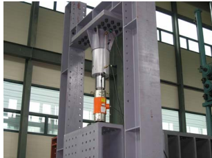
그림 7. 좌측 그림 8. 우측 수평유지 유압잭 그림 9. 실험 진행상황
