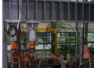
그림 5. 수평유지 유압잭의 설치 및 작동원리 그림 6. 유압잭 설치 및 유압포트 연결 상황
