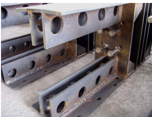
그림1. Perfobond rib 연결부
